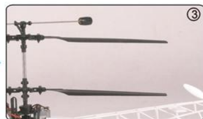
(3) 主旋翼旋转在同一平面 Main blades rotate in one plane.
